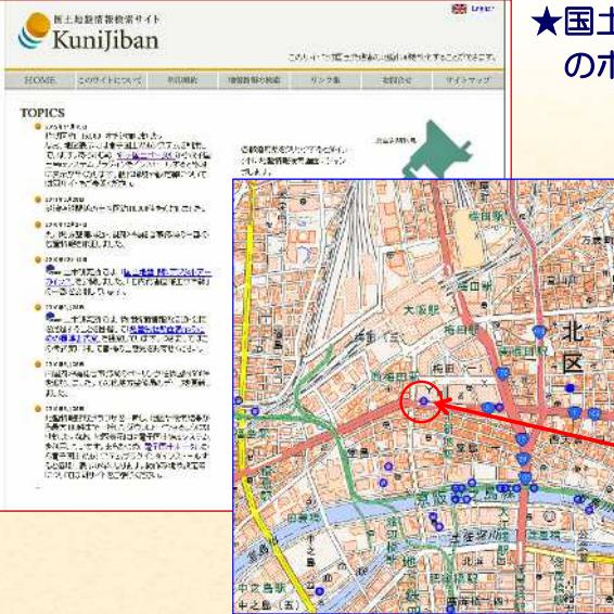
地図上のマーカーをクリックすると、ボーリング柱状図(イメージ)と、再処理可能な ボーリングデータ(XML形式)が無償で提供される
